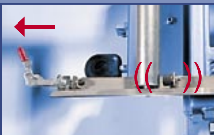
Lockable roller conveyor Arretierbare Rollenauflage
